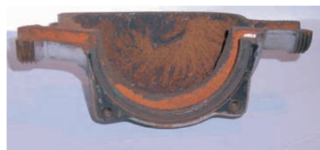
Ausfall einer Heizungspumpe aufgrund Steinbildung
